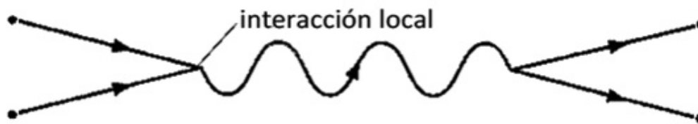
Figura 6.6 En la teoría de campos cuántica, una partícula y su antipartícula pueden momentáneamente aniquilarse mutuamente, produciendo un fotón. Luego, este fotón puede originar otra partícula y antipartícula que viajan en diferentes trayectorias.
